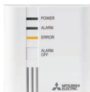
Błąd (czujnika, połączenia)
